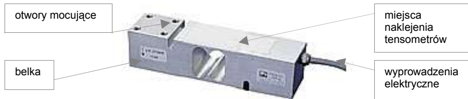
Rys. 9. Belka tensometryczna.
