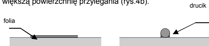
Rys. 4b. Powierzchnia przylegania ma wpływ na naprężenia styczne pomiędzy przewodnikiem a podkładem.
